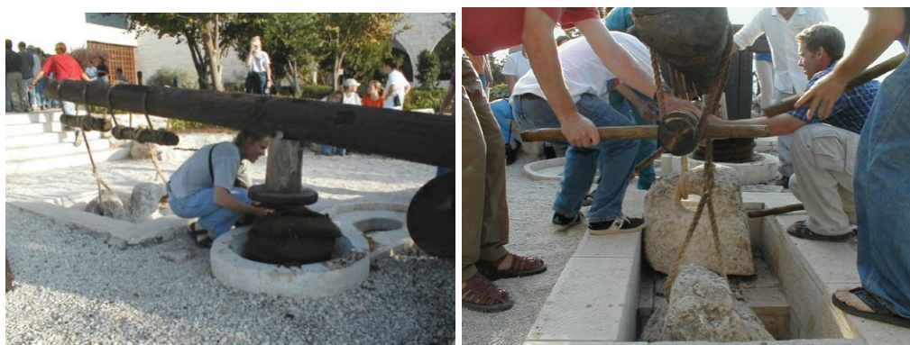
Εικόνα 15 Αναπαράσταση μηχανής πίεσης του ελαιοπολτού με μοχλό, Γεσθημανή
